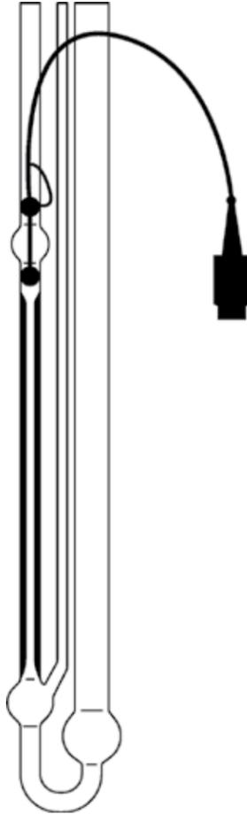
Viskosimeter mit hängendem Kugelniveau zur Bestimmung der absoluten und der relativen Viskosität. Die Messebenen werden durch TC-Sensoren markiert, der Meniskusdurchgang wird aufgrund der unterschiedlichen Wärmeleitfähigkeit der Flüssigkeits- und der Gasphase detektiert. Ein Messstativ der Typen-Reihe AVS®/S ist nicht erforderlich. Mit TC-Viskosimetern kann die kinematische Viskosität aller Flüssigkeiten mit newtonischem Fließverhalten bestimmt werden.
