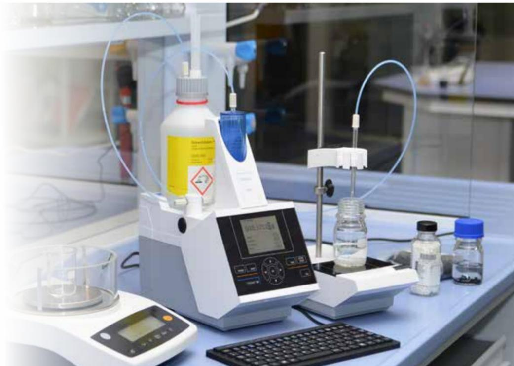
Außer der Probeneinwaage kann in der Software der Titronic® 500 auch der Gehalt von Fremdbestandteile wie z.B. Glasfasern eingegeben werden: Dieser Anteil der Einwaage bleibt für die Berechnung der Lösemittelmenge unberücksichtigt. Damit wird die zu dosierende Lösemittelmenge nur in Bezug auf die reine Polymermenge berechnet, entsprechend den Viskosimetrie-Normen, z.B. ISO 1628 oder ISO 307.
